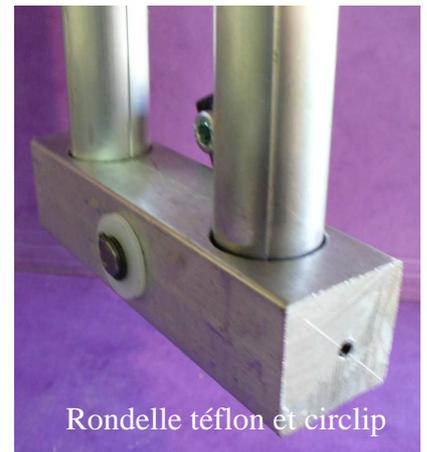
Rondelle téflon et circlip
