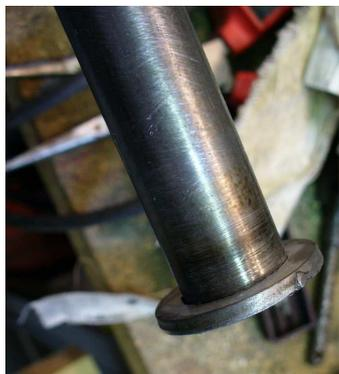
Nous avons soudé une rondelle en bout de tube. Elle servira de butée, ainsi la tête ne pourra pas tomber. Le trou dans la tôle d'aluminium étant plus petit. Ensuite, un classique pour vous maintenant, un roulement est fixé sur l'axe tubulaire. Il est
