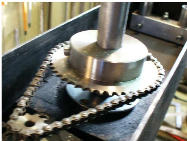
On traverse complètement, car nous allons tarauder des 2 côtés. Nous pourrons ainsi mettre deux vis, pour un meilleur serrage. Comme les outils sont sortis, on fait pareil sur les 4 pignons. Comme ça, c'est fait ! On en parle plus. Pour les ignares du taraudage, il y a un tutorial sur le site au rayon "Conseil d'atelier".
