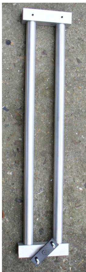
Les tubes sont fixés avec des goupilles fendues de  $\varnothing$  4mm. L'ensemble ne bouge pas, mais reste démontable en cas de soucis. Sur la photo de gauche, on aperçoit la pièce qui permettra au berceau de caméra de tourner librement. C'est la prochaine étape.
