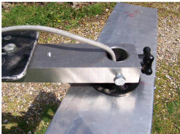
Voilà le système de fixation de la tête. Dans un barreau d'aluminium de 25mm X 50mm nous avons percé 1 trou de Ø30mm. Le tube servant d'axe rentre dans cette pièce. Une vis de M8 rentre légèrement dans un trou de l'axe servant ainsi de sécurité. Les deux vis sur les côtés servent à bloquer légèrement l'axe de la tête et, ainsi, éviter le jeu.
