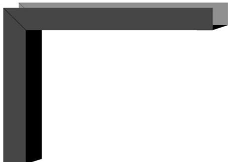
Ce squelette de base a été réalisé en tôle d'aluminium de 3mm, pliée, puis soudée pour raccorder les deux parties. Nous avons la chance de pouvoir faire travailler et souder l'alu par un ami. Vous pouvez aussi la réaliser en tôle d'acier (1 à 2 mm) le poids de base ne changera pas beaucoup. L'intérieur du profilé, ainsi réalisé, fait environ 10cm X 6cm. Ce qui nous laisse une place confortable pour installer moteurs et accessoires mécaniques.
