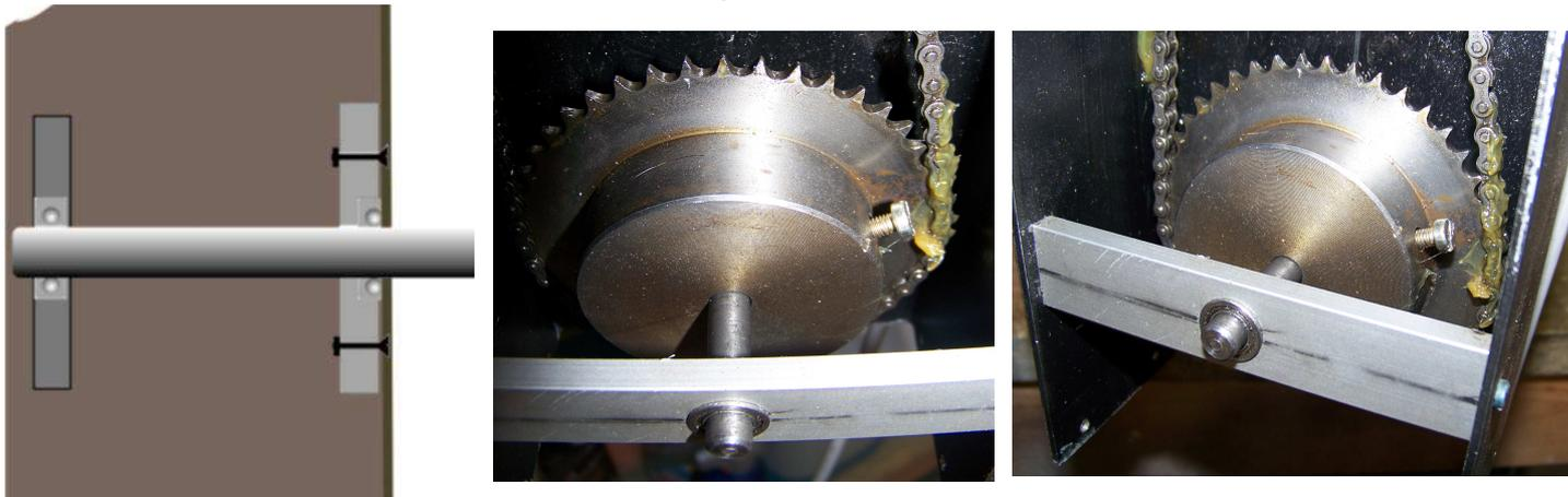
L'axe passe donc par deux roulements, écartés d'environ 5cm tout est parfaitement aligné, bref, ça tourne rond. Vous avez choisi chaîne ou courroie. Et vous avez calculé les diamètres nécessaires. Reste à choisir et à fixer le moteur.
