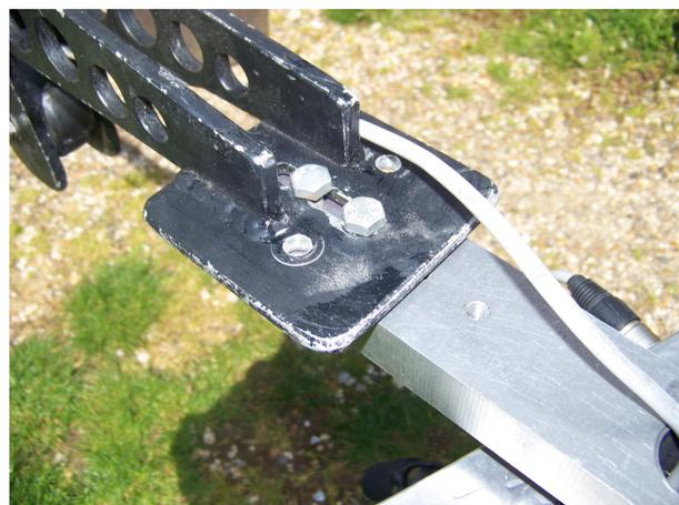
La longueur de cette pièce importante est calculée, en fonction de votre grue. La tête, doit pouvoir tourner librement, sans toucher aucune pièce de la grue; mais le porte à faux doit être minimum. Le câble de commande passe tranquillement au milieu de l'axe.
