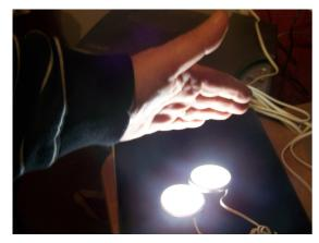
Des éclairages à leds de 6 cm de diamètre pour 5 à 6 mm d'épaisseur. C'est vendu par 4, pour quelques dizaines d'euro. Lors d'un tournage nous en avons fixé dans un véhicule, avec du scotch double face! Le visage du conducteur était parfaitement éclairé. Comme l'ensemble fonctionne en 12v continu, il était branché directement sur l'allume cigare!
