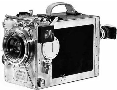
Dès 1924, André Debrie conçoit un système d'entraînement électrique substituable à la manivelle. Dans les années qui suivent, le moteur électrique (ou le moteur mécanique à ressort pour les caméras portables) est intégré directement à l'appareil et amène la disparition progressive du tournage manuel. Le parlant, avec son exigence de synchronisme absolu, impose définitivement la solution du moteur électrique.
