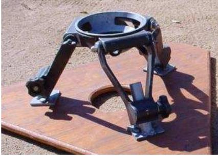
D'autres solutions existent pour fixer une caméra. Des embases courtes pour des prises de vues basses. Ces mêmes supports bas peuvent être vissés sur un cube en bois pour en ajuster la hauteur.
