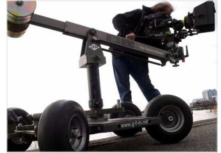
Un autre "bras" est souvent utilisé, il se nomme U-Bangui. Il permet de déporter la caméra et autorise un mouvement rotatif autour de la Dolly. Il ne permet pas les mouvements verticaux. Par contre ses mouvements de translation horizontaux sont d'une extrême douceur et très précis.
