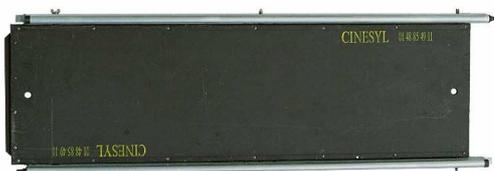
On peut aussi monter entre ces rails un plancher en bois ; pour le pousseur, mais surtout quand un comédien doit avancer dans l'axe de la caméra.
