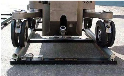
Il existe aussi des roues, en caoutchouc dur, qui sont utilisées à la fois sur sol et sur rail. Dans ce cas le sol doit être parfaitement plat car contrairement aux roues pneumatiques, ces modèles n'absorbent aucun choc. A réserver aux studios ou sur plateau de
