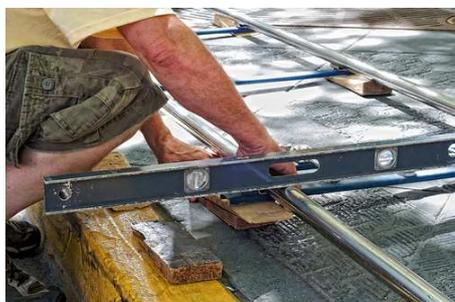
Pour que ces calages soit parfaitement de niveau, il faut obligatoirement un NIVEAU à bulle un vrai un classique. Pas un gadget laser qui fait calelette et tire-bouchons en même temps (même si le tire-bouchon est aussi un outil indispensable !). Prenez le solide et assez large pour vérifier des rails de travelling par exemple, soit 70 cm minimum. Les niveaux plastiques de 20cm servent à ... rien ! Deux c'est encore mieux, car vous pourrez travailler à plusieurs.
