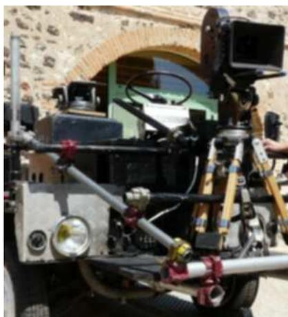
Beaucoup de fixations de caméra et d'éclairages sur les véhicules, sont fabriqués sur ce principe. Prenez exemple sur la photo ; il faut prévoir beaucoup de crochets doubles.
