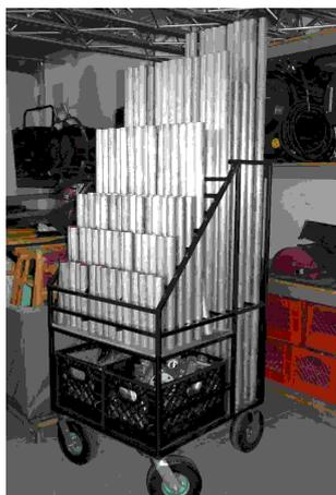
Encore des choses qui servent énormément. Des longueurs de tubes aluminium de Ø 50mm et des crochets doubles pour les assembler. Vous accrocherez ainsi caméra, projecteurs, ou borniols presque n'importe où.
