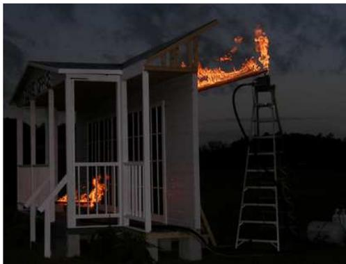
Pour ce genre de plan on utilise des "rampes à gaz". C'est-à-dire des tubes percés reliés à des bouteilles de gaz propane. On peut ainsi régler le débit, donc la hauteur des flammes en toute sécurité.
