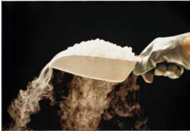
Lorsque la glace carbonique (CO<sub>2</sub>) entre en contact avec une source de chaleur (de préférence de l'eau chaude), il se produit un effet de sublimation (passage de l'état solide à l'état gazeux). Le gaz carbonique est alors libéré pour former la fumée blanche recherchée. Plus l'eau est chaude, et plus la fumée dégagée sera intense. Si vous placez la glace carbonique dans une eau teintée, la fumée dégagée sera elle-même colorée.
