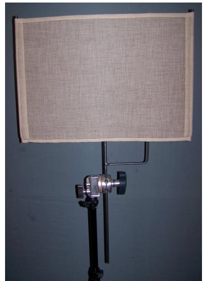
Il s'agit d'un U en fer rond de Ø8mm sur lequel est soudé, au milieu, une tige de 40 cm qui permettra de l'installer dans une rotule. Une poignée en fer rond de Ø6mm et de 10cm X 5 cm sert à le tenir et aussi à le rigidifier. Voilà pour le cahier des charges.
