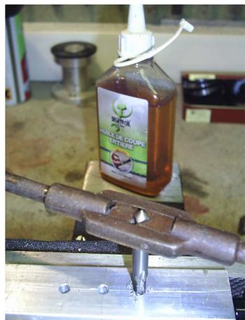
Voilà c'est presque fini ! Vous trouverez ci joint un tableau avec les diamètres de perçage correspondant aux diamètres des vis que vous utiliserez le plus souvent. Deux diamètres sont en pouces, ils correspondent au pas des vis de caméra ou de microphones ; Mais ces tarauds ne se trouvent pas dans la distribution classique (CASTOMERLIN). Ou peut-être sur commande ? Sinon vous les trouverez en Angleterre ou par le biais de fournisseurs de l'industrie.
