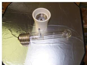
Ensuite, on installe la douille E40, on passe le fil dans le tube, on câble la douille, et on la fixe au centre ; pile au dessus du trou. Le paquet de cigarette vous donne une idée de la taille de la douille.
