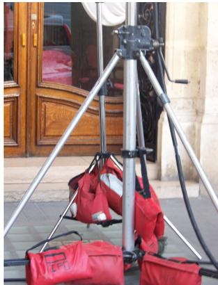
N'oubliez pas les poids pour stabiliser ces pieds ; surtout les grands ! Une blonde à 3,50m du sol avec volets, spun et correcteur ... c'est pas stable ! Et si en plus il y a du vent ... Le plus simple est d'utiliser des sacs à sable (sand bags) voir tuto sur le site pour les fabriquer.
